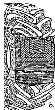
Сл.13.43: Распоред и положај нити: а) дијагонални, б) радијални пнеуматици
