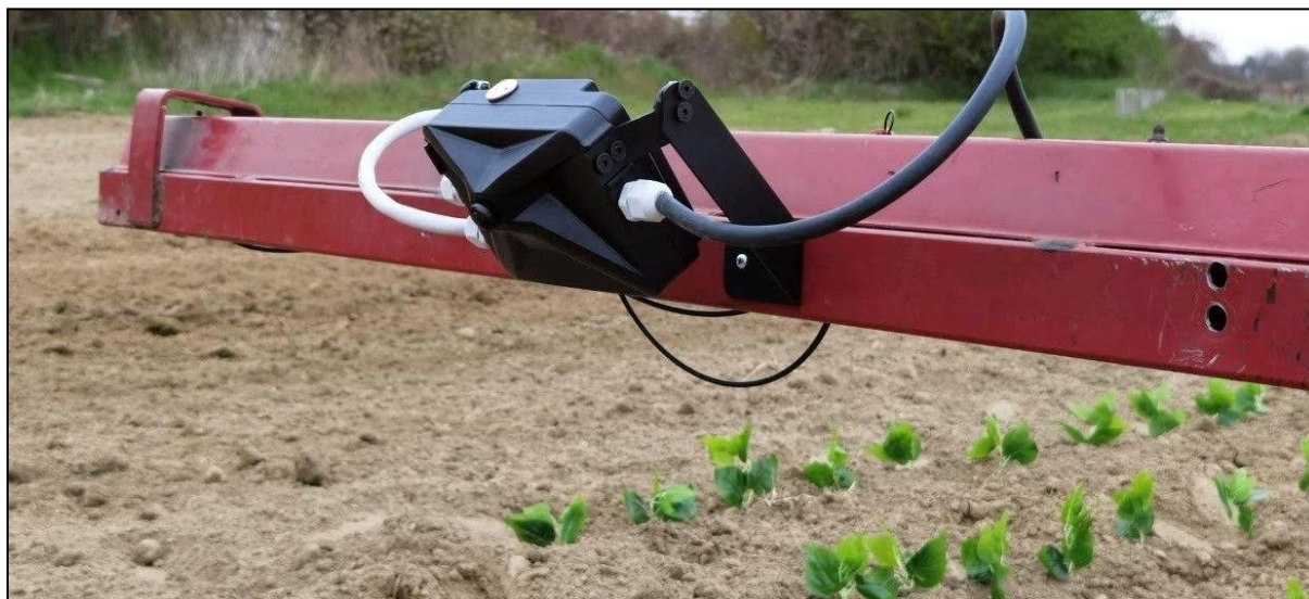
Слика 61. Сензор за детекцију корова на прскалици (оригинал, Милан Благојевић)
